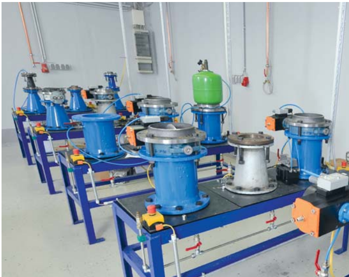
Bild 3: Testaufbau im werkeigenen Versuchsraum zur Durchführung von Dauerprüfungen und Schaltzyklen
