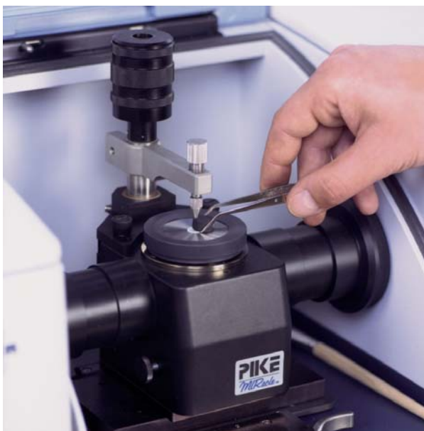
Bild 4: Die Infrarotspektroskopie ermöglicht die Überprüfung der vorgegebenen Elastomerqualitäten
